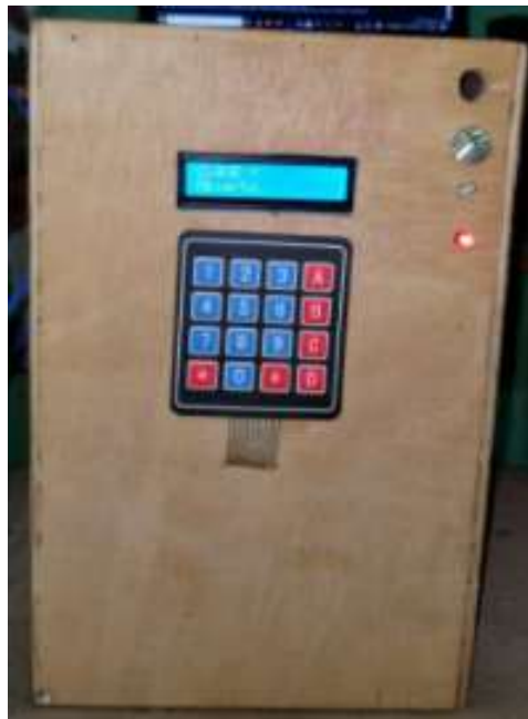
Fig. 8. Prototipo en estado abierto indicado mediante la LCD y el LED encendido de color rojo.
